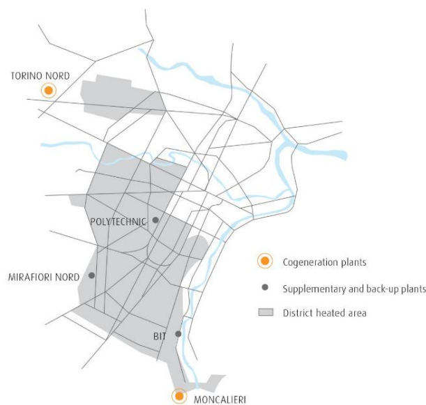
Abbildung 64: Schema des Fernwärmenetzes von Turin mit zwei Hauptstationen und den zusätzlichen Unterstationen für den beheizten Bereich [11]
