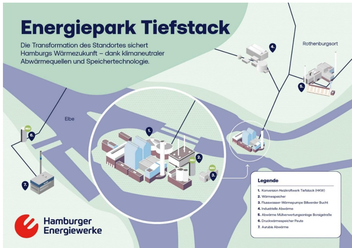
Abbildung 93: Das Erzeugungskonzept des Energieparks Tiefstack [12]
