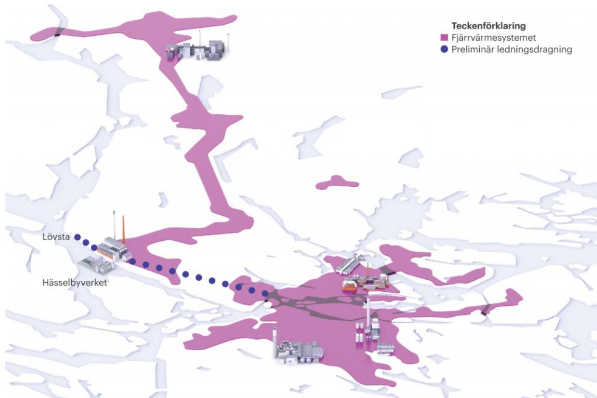
Abbildung 75: Neu geplante Verbindungsleitung Lövsta [40]
