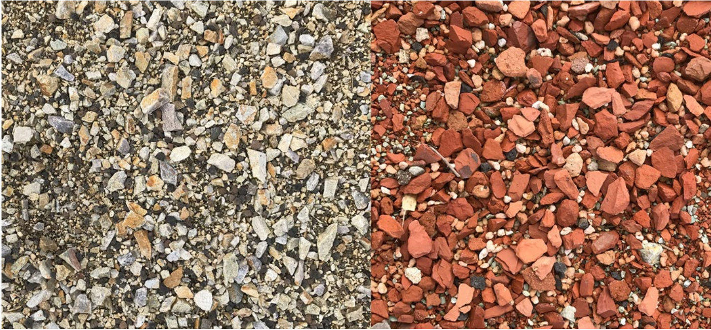
Substratmischung mit unterschiedlichen Materialien und Korngrößen | © GREEN4CITIES
