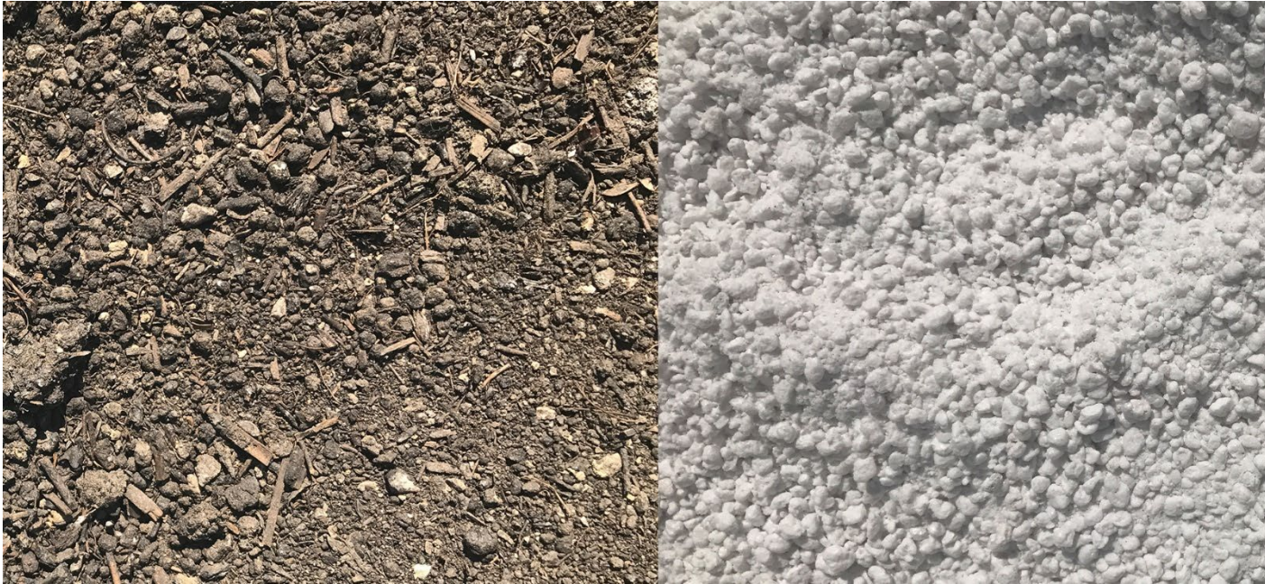
Links: Kompost als Füllmaterial | © GREEN4CITIES, rechts: Perlite als Füllmaterial | © GREEN4CITIES
