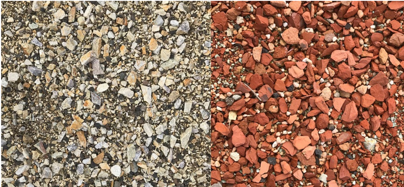
Substratmischung mit unterschiedlichen Materialien und Korngrößen | © GREEN4CITIES
