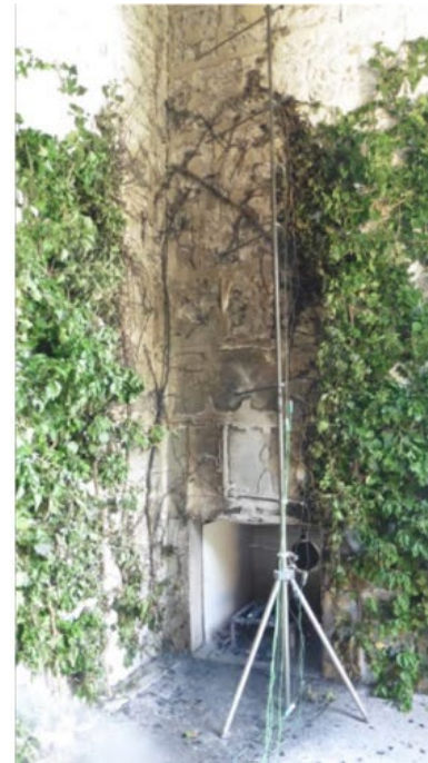
Brandversuch Fassadenbegrünung / Wien / links: vor dem Brandversuch, Mitte: während des Brandversuchs, rechts: nach dem Brandversuch, alle Bilder © Stadt Wien – Umweltschutz
