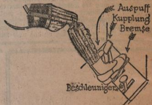
Beinprothese für einen Fahrermann.
